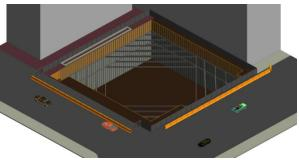
FIGURE 3: SLURRY WALL DETAIL WITH DIAGONAL BRACED
