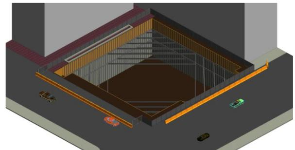
FIGURE 3: SLURRY WALL DETAIL WITH DIAGONAL BRACED
