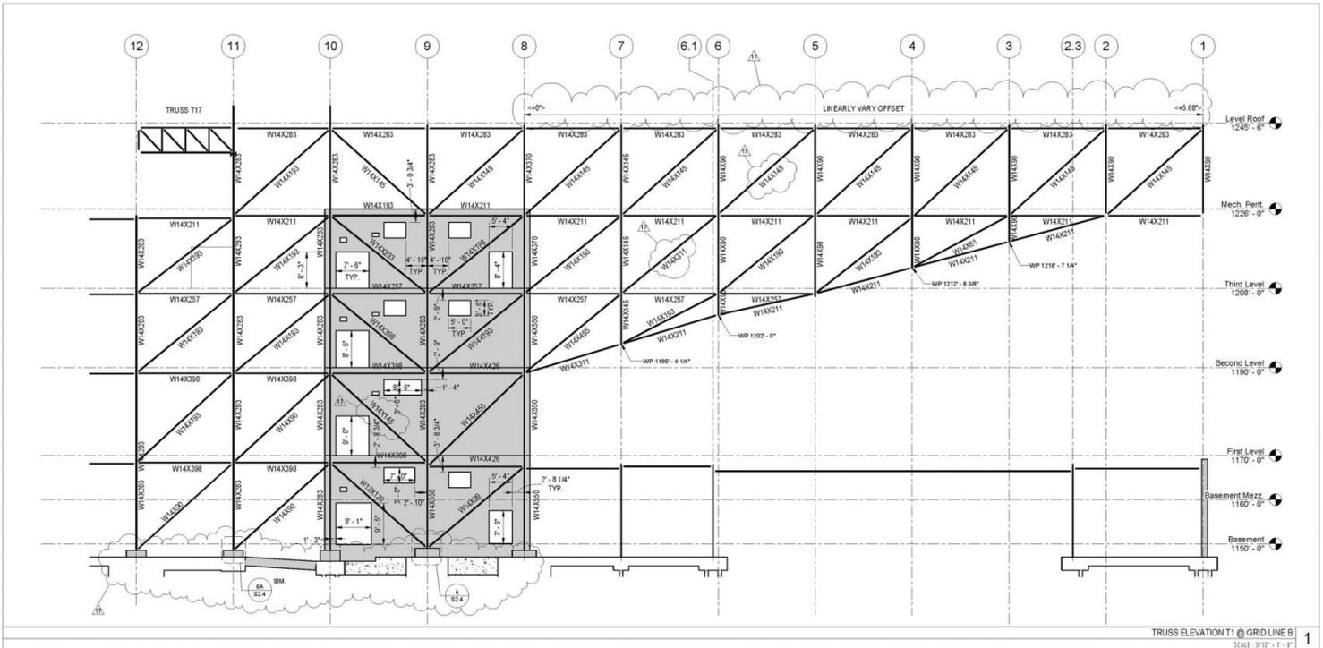
TRUSS ELEVATION T1 @ GRID LINE B
